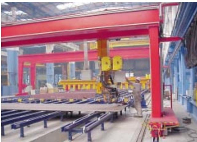
Fillet portal (KWW).
